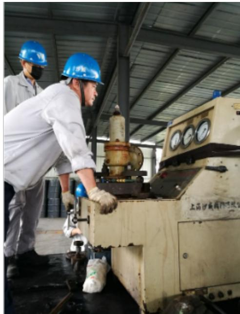
安全阀是一种自动阀门，他不借助任何外力而利用介质本身的力量来排出额定数量的流体，以防止系统内压力超过预定的安全值。当压力恢复正常后，再自行关闭并阻止介质继续流出的一种阀，包括直接载荷式安全阀、先导式安全阀、动力辅助装置的安全阀等。安全阀定期校验：1. 校验周期：安全阀校验周期应当符合以下要求：（1）安全阀定期校验，一般每年至少一次，安全技术规范有相应规定的从其规定；（2）经解体、修理或更换部件的安全阀、应当重新进行校验。2. 离线校验：指在离线状态下，将安全阀从设备上拆下，对安全阀进行的校验。校验项目包括整定压力及密封试验压力。3. 在线校验：指在在线状态下（安全阀安装在设备上受压或不受压状态下）对安全阀进行校验。校验项目为整定压力。安全阀校验的人员在校验的过程当中一定要听从指挥。南京电厂安全阀校验检定
