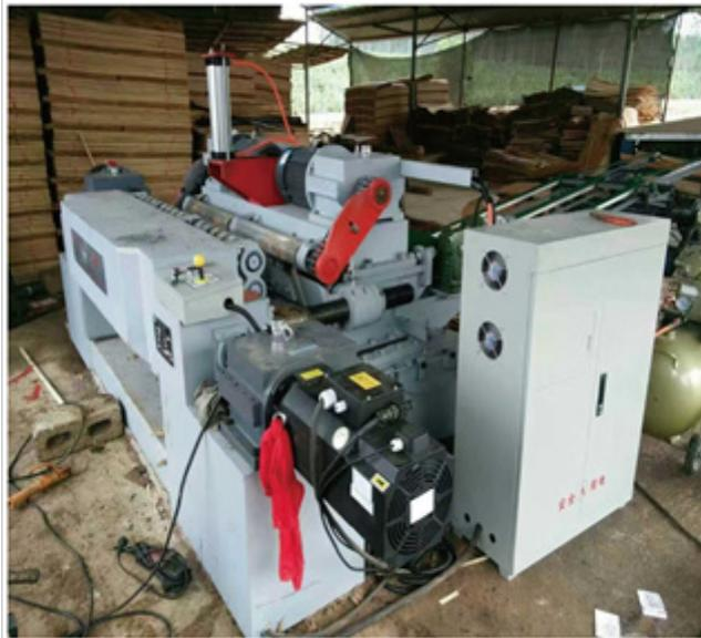
无卡数控旋切机在旋切木材的时候，木材是在两个固定滚和一个移动滚的驱动之下旋转的，动驱动滚的中心支承和刀具的相对位置是固定的，在驱动电机的带动下，刀具通过移动把旋转运动的圆木旋切出单板，单板的厚度可通过动滚与刀口的间隙和刀具的移动速度来调整。圆木的转速是不变的，但随着对圆木的旋切，圆木的直径会变小，这样转一圈的时间会发生变化，旋切刀具的移动速度也要随之变化。从上面的工作原理中我们不难分析出设备出现啃刀的原因，造成故障的原因有两点：1、木轴直径过大的时候，会因为刀口过大，单辊又太低，压力小从而才出现了啃刀的情况。2、也可能是因为旋切木芯时的刀口过小，单辊过高，而压力过大造成了啃刀的情况出现。海太机械您的满意就是对我们的支持。贵州旋切机\*\*款
