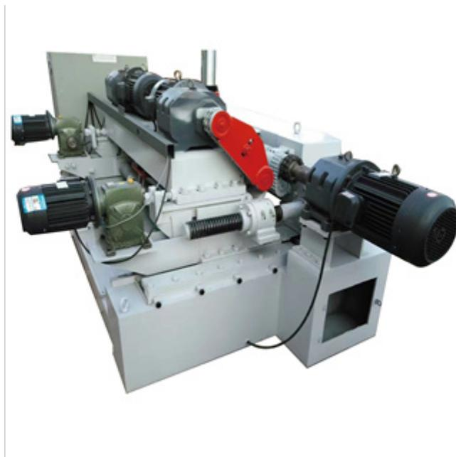
我们知道现在市面上的旋切机是可以把木材旋切出很薄木皮的，但如果机器出现故障，会使旋切出的木皮质量受到影响，同样也影响到了生产的效率，所以，为大家介绍几点常见的旋切木皮问题，相信会对大家有所帮助。1、木皮打卷：这种情况一般主要是由于刀门过窄或者刀架过高造成的。解决方法很简单，要两头的滑枕螺丝和调节螺丝松开，把刀门放宽点，再把刀具的高度降低，然后紧固好螺丝，这样就可解决木皮打卷的问题。2、木皮厚度不匀：主要是由于测距或测速编码器或电子尺部分出现损坏。解决方法：把快进频率调至2Hz□观察原木的直径变化是不是连续，如果还有停顿的现象则说明测距编码器坏了，需要更换。如果辊子的转速与实际的转速不一致，则需要更换测速编码器。3、旋切出的木皮呈波浪形：这种情况一般是由于进刀的阻力过大造成的。解决方法：检查空转时变频器输出的电流是否大于5安，如果超出需要调整机器，检查是否润滑不好造成的阻力过大。
